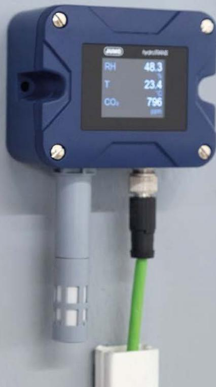
Die HydroTrans überwacht Feuchtigkeit, Temperatur und CO<sub>2</sub>-Gehalt in der Produktion bei Jumo.
